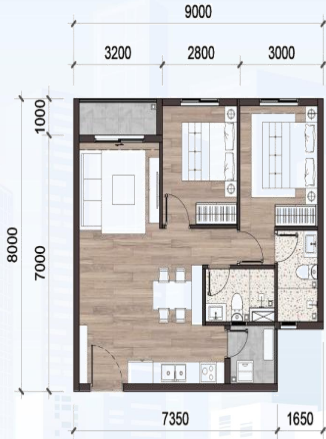
THIẾT KẾ MODULE PRECAST CĂN HỘ 2PN ĐIỂN HÌNH
