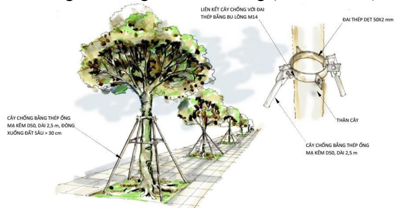
Hình 18. Phòng và giảm thiểu thiệt hại cho cây xanh bằng thanh chống thép
