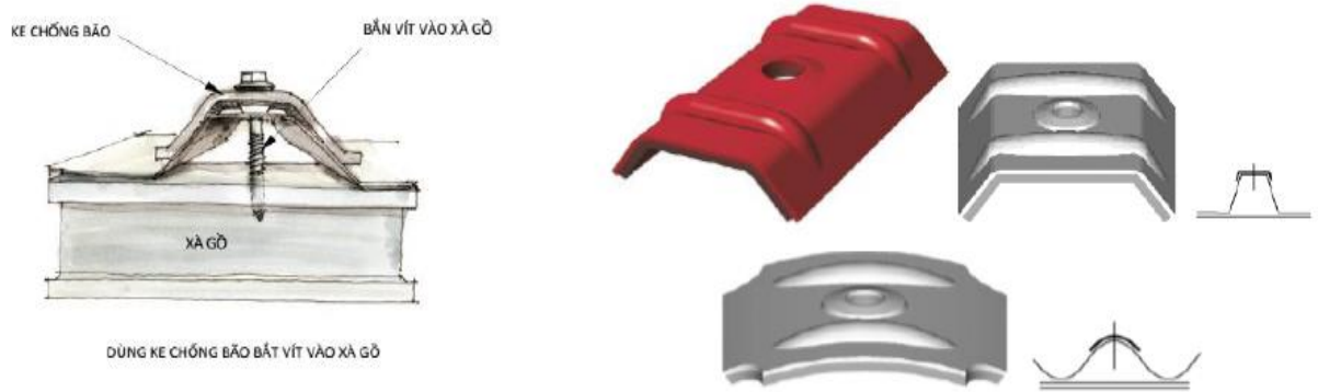
Hình 11. Gia cố phòng chống tốc mái tôn bằng ke chống bão
