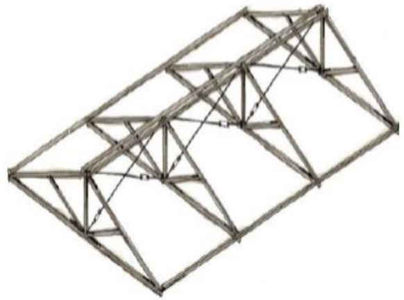
b) Hệ khung mái được gia cố bằng giằng chéo để chịu gió bão
